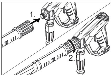
→ A fúvókát szerelje a fel sugárcsőre (jelzések az állítógyűrűn fent), és húzza meg kézzel (EASY!Lock).
