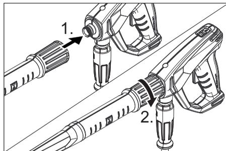
→ 将喷嘴装配到喷射管上（定位环上的标记向上）并用手拧紧（EASY!Lock）。
