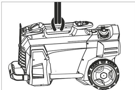
➔ Στερεώστε τη διάταξη ανύψωσης στη λαβή μεταφοράς της συσκευής.
