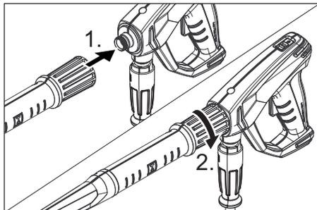
→ Montați duza pe lance (marcajele de pe inelul de reglare trebuie să fie în sus) și strângeți-o manual (EASY!Lock).
