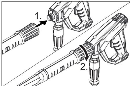
→ Montera munstycke på strålröret (märkning upptill på inställningsringen) och dra åt för hand (EASY!Lock).
